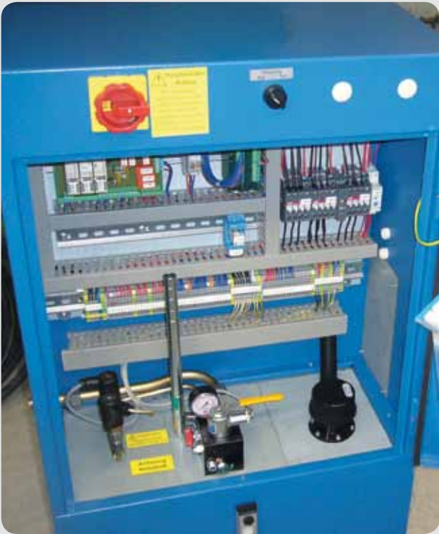
Armoire de commande ouverte, dans la zone du bas, de gauche à droite les électrovannes et le bloc de commande, les contacteurs au milieu de la commande et en haut à gauche, l'interrupteur principal
