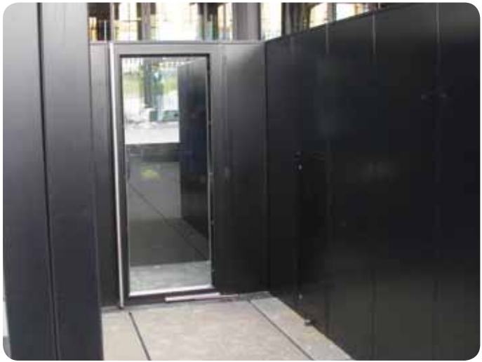
Porte un vantail: V2A peint en RAL 9005, charnières à l'intérieur, grande surface vitrée, poignée barre sur toute la hauteur de la porte, sans linteau
