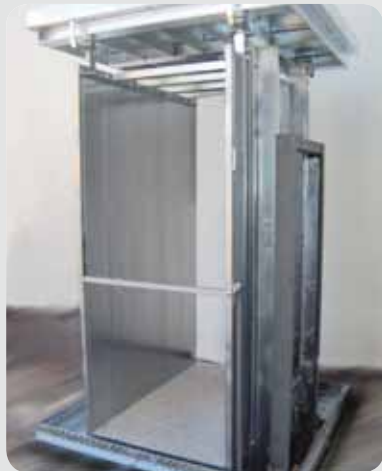
Construction de base et plancher (tôle striée) zingué au feu, parois cabine zingué au feu, pas de plafond seulement cadre de toit, arcade primaire poudre riche en zinc
