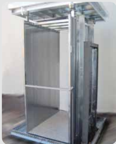
Grundkonstruktion und Boden (Tränenblech) feuerverzinkt, Kabinenwände feuerverzinkt, keine Decke nur Dachrahmen, Laufwagen zinkstaubgrundiert
